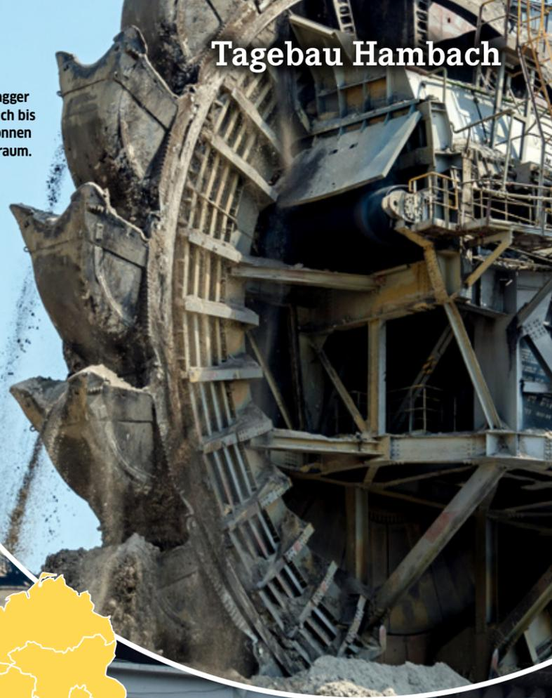
Die größten Schaufelradbagger bewegen täglich bis zu 240.000 Tonnen Kohle und Abraum.
