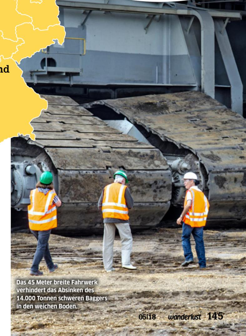
Das 45 Meter breite Fahrwerk verhindert das Absinken des 14.000 Tonnen schweren Baggers in den weichen Boden.
